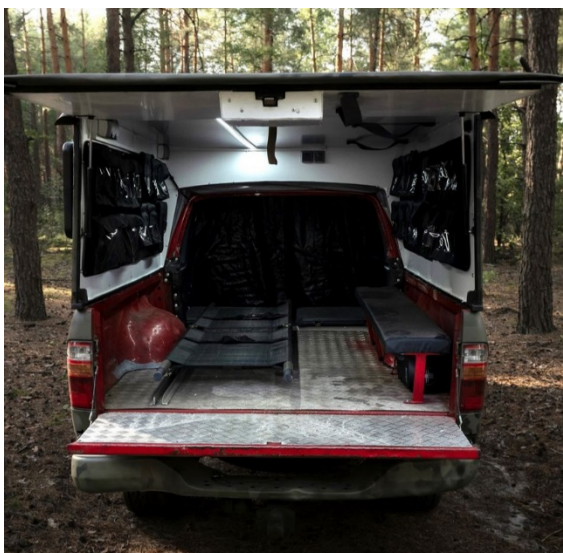
Figur 3. Bår och bänk. På bänken kan patienter och vårdare sitta alt. en patient ligga.
